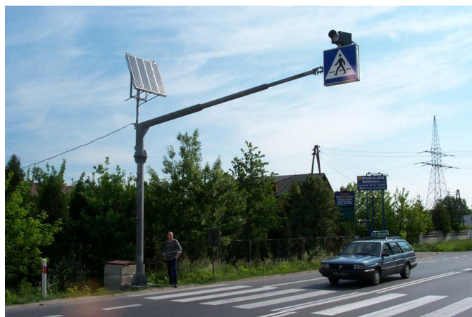
Znak drogowy D6 wyposażony w system PV
