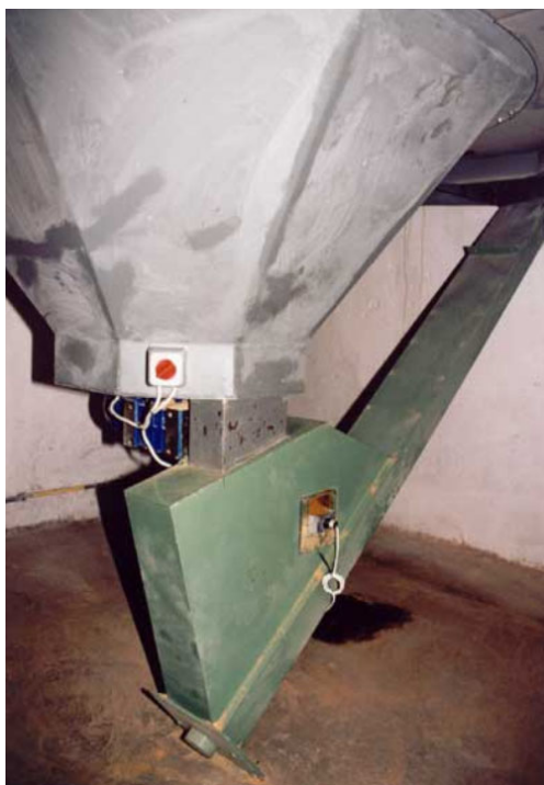
Zdj. 3. Zasobnik z podajnikiem ślimakowym
